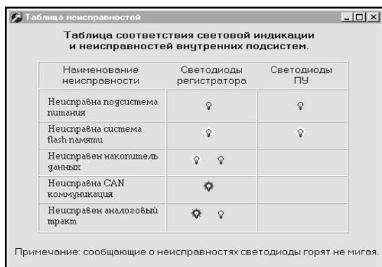
Здесь же расположена кнопка «**Таблица неисправностей**», нажатие на которую выводит на экран таблицу состояний светодиодов на лицевых панелях регистратора и ПУ после проведения самотестирования комплекса.
